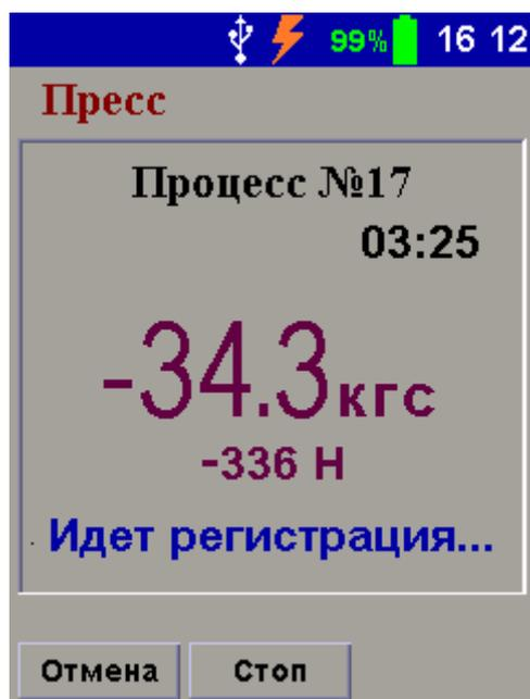
Можно остановить процесс регистрации без сохранения, нажав функциональную клавишу «Отмена» или с сохранением, нажав «Стоп». Прибор автоматически перейдет в ручной режим измерений.
