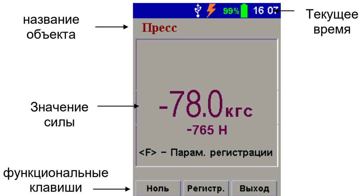
Перед началом измерений нажатием функциональной клавиши "Ноль" обнуляются показания датчика измерения силы.
