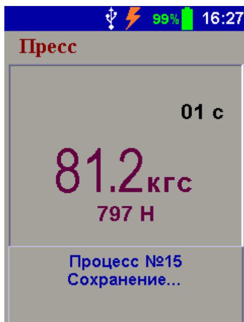
Регистрация текущих измерений происходит при нажатии функциональной клавиши «Регистр.» в течение выбранной ранее в меню параметров длительности, с интервалом 1 сек. Все данные автоматически заносятся в динамический архив.
